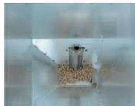
El tanque del granulado puede contener 120 litros / 80 kg de granulo para garantizar una larga autonomía
