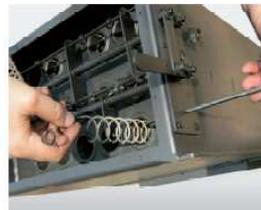
Desmontaje fácil de las varillas para limpiar las tuberías durante la manutención periódica.
